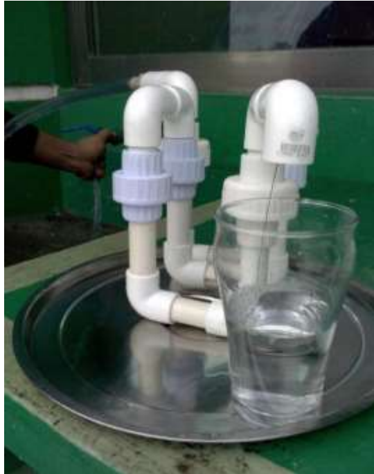
Figura 17 Paso del agua potable a través del filtro por medio de la red de abastecimiento del ITSM
