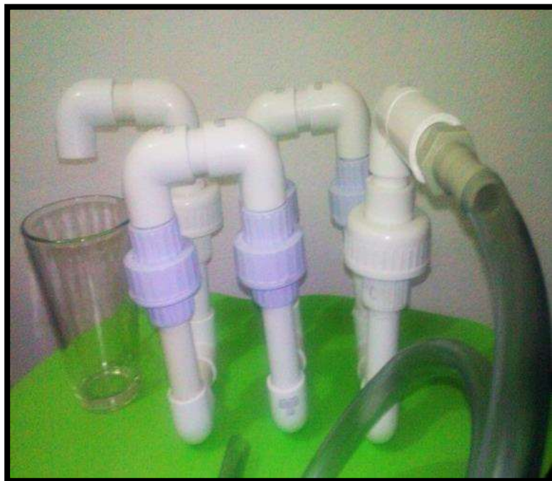
Figura 13 Filtro semi-portátil terminado
