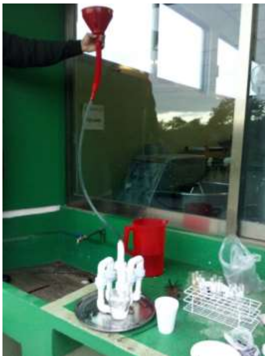
Figura 18 Se observa el embudo conectado a la manguera de paso del filtro semi-portátil, para facilitar el paso del agua de las muestras del Río Misantla
